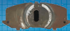
通常使用による錆
